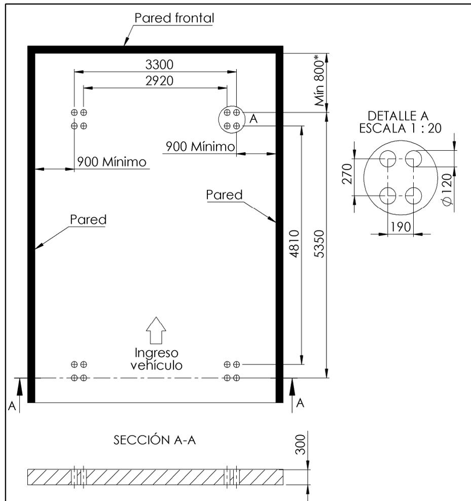
**Nota:** - Dimensiones para instalación con anclaje.
